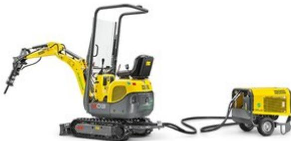
Гусеничный экскаватор 803 Dual Power это легкий дизельный экскаватор с возможностью питания от трехфазной розетки с помощью электрогидравлического привода HPU 8. Это инновационное решение позволит работать абсолютно без выбросов в окружающую среду. Компактные размеры этого гусеничного экскаватора позволяют осуществлять работы даже внутри не проветриваемых помещений и зданий. Подробно о возможностях этого экскаватора Вы сможете посмотреть на видео размещенного на вкладке описание.
